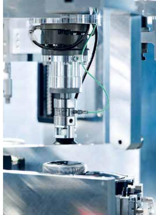
Misurazione della forza di compressione verticale con sensore di forza piezoelettrico tipo 9311
